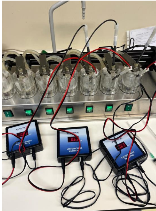
Fig. 5 Ensaio de permeação cutânea ‘ElectroPeloTerapia’
